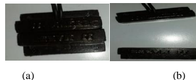
Figura 2. Sensor magnético, (a) Cerrado, (b) Abierto
